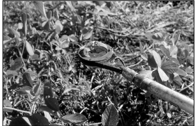
Figura 1. Radiômetro líquido danificado por ataque de pássaros.
