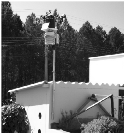
Figura 7 - Estação Meteorológica instalada sobre área do telhado verde (Protótipo B).
