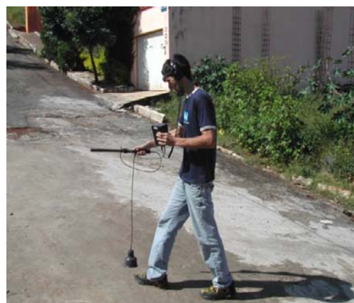
Figura 2 - Campanha de campo para a verificação da existência de vazamentos
