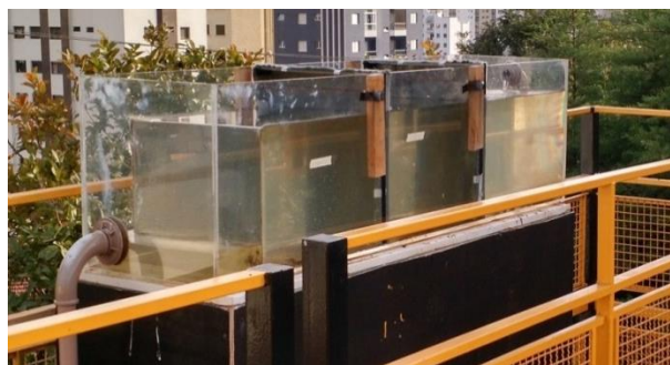
Figura 1 - Canal utilizado no experimento com as barreiras instaladas
