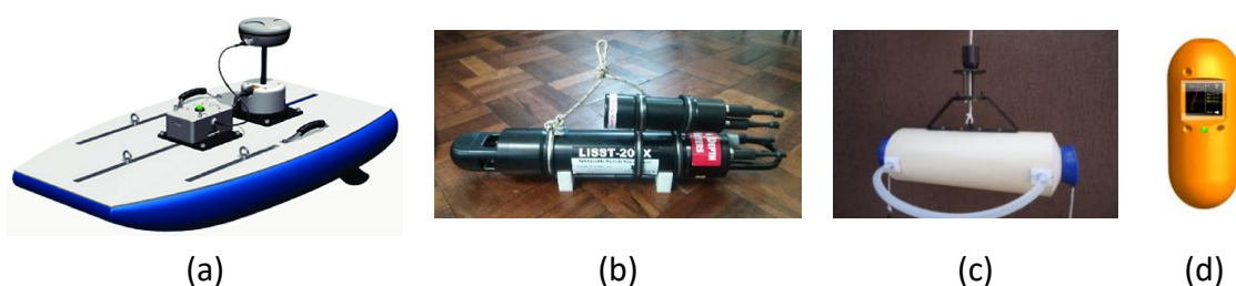
Figura 2 – Equipamentos utilizados: (a) ADP-M9 da Sontek/Xylem, (b) LISST-200X da Sequoia Scientific, (c) Garrafa Van Dorn e (d) CTD da Sontek/Xylem.
