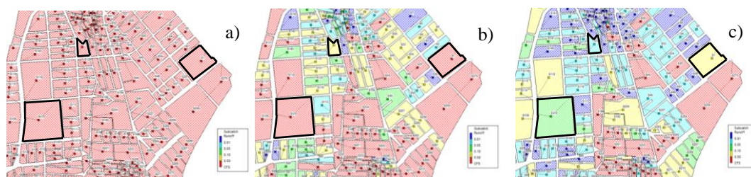
Figura 8: mapas com a identificação das quadras analisadas gerados após a simulação no SWMM SEM LID. a) Imediatamente após a chuva; b) 30 minutos após a chuva e c) 60 minutos após a chuva.
