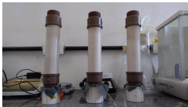
Figura 3: Filtros para simulação do substrato do telhado verde.
