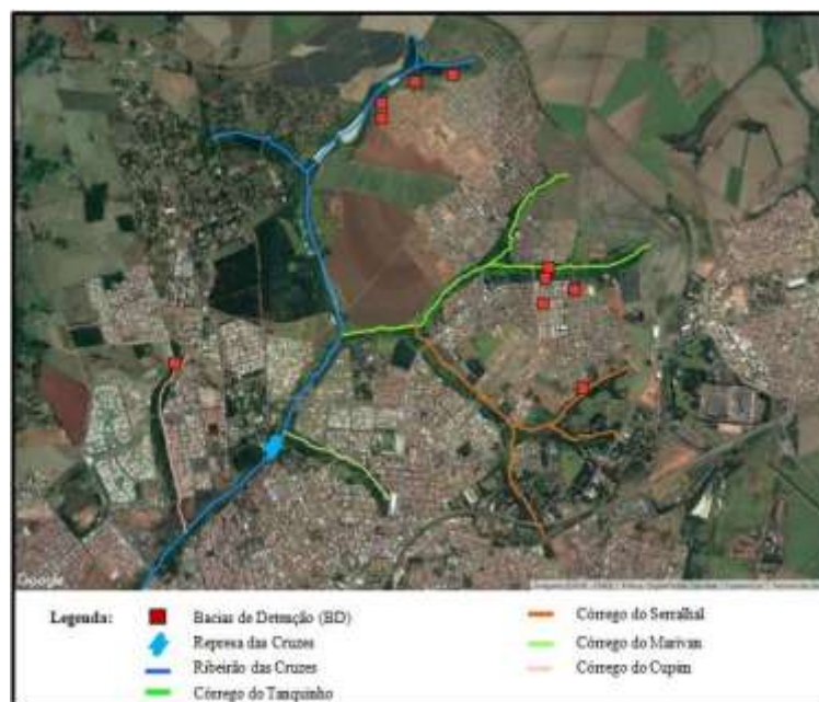
Figura 2 – Unidades de retenção localizadas em loteamentos abertos no Município de Araraquara. Fonte: Adaptado do Google Earth 2017
