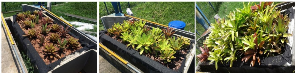
Figura 3: Protótipo experimental do telhado verde.
