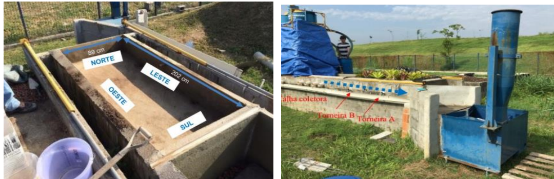
Figura 1: (a) Identificação das faces do protótipo - FONTE: Bruno (2016) e (b) Simulador, drenos, calha e caixa pluviométrica - FONTE: Garrido Neto (2016)
