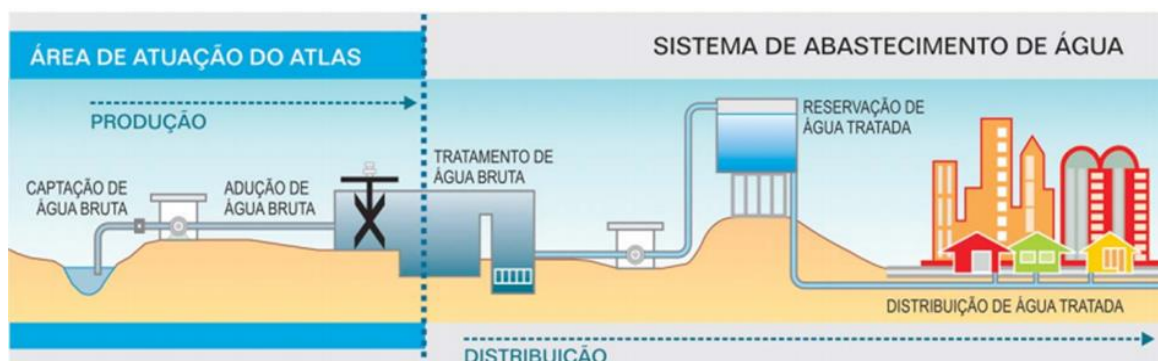
Figura 1 – Sistema de abastecimento de água.
