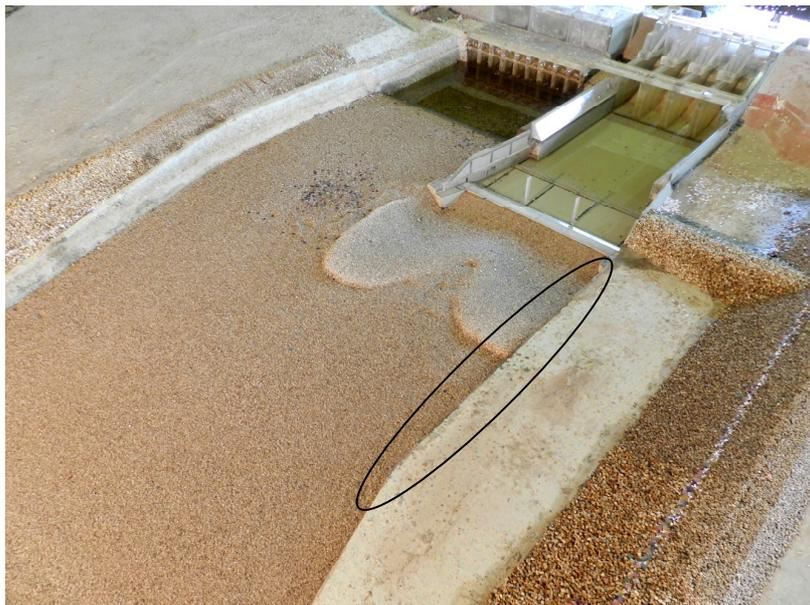
Figura 8 – Resultado do ensaio de erosão após modificação na configuração da bacia de dissipação- Simulação da vazão de 4.555 m<sup>3</sup>/s (Tr=100 anos) passando pelo vertedouro
