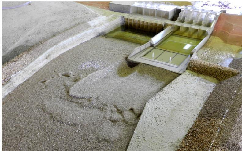
Figura 5 – Resultado do ensaio de erosão após simulação da vazão de 4.555 m<sup>3</sup>/s (Tr=100 anos) passando pelo vertedouro – Estimativa inicial da fragmentação do arenito utilizando material granular de diâmetro médio de 24 cm (dimensão transposta para valor de protótipo) e remoção das barras formadas durante o ensaio
