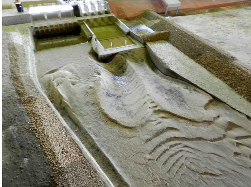
Figura 4 – Resultado do ensaio de erosão após simulação da vazão de 4.555 m<sup>3</sup>/s (Tr=100 anos) passando pelo vertedouro – Estimativa inicial da fragmentação do arenito utilizando areia peneirada de diâmetro médio de 6,5 cm (dimensão transposta para valor de protótipo) e remoção das barras formadas durante o ensaio
