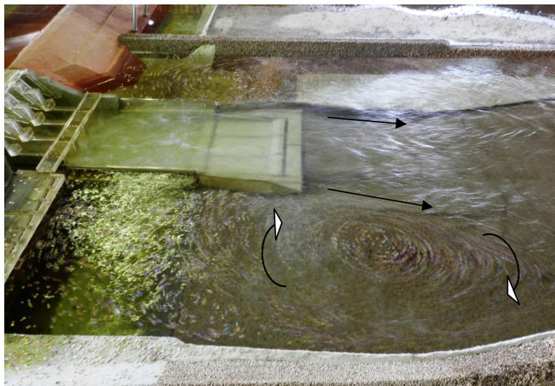
Figura 6 – Ensaio de erosão original simulando vazão de 4.555 m<sup>3</sup>/s (Tr=100 anos) passando pelo vertedouro – Interação do escoamento proveniente do vertedouro e das correntes de retorno
