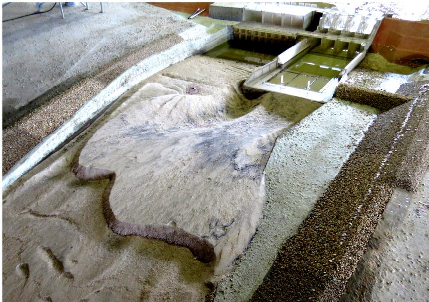
Figura 3 – Resultado do ensaio de erosão após simulação da vazão de 4.555 m<sup>3</sup>/s (Tr=100 anos) passando pelo vertedouro – Estimativa inicial da fragmentação do arenito utilizando areia peneirada de diâmetro médio de 6,5 cm (dimensão transposta para valor de protótipo).
