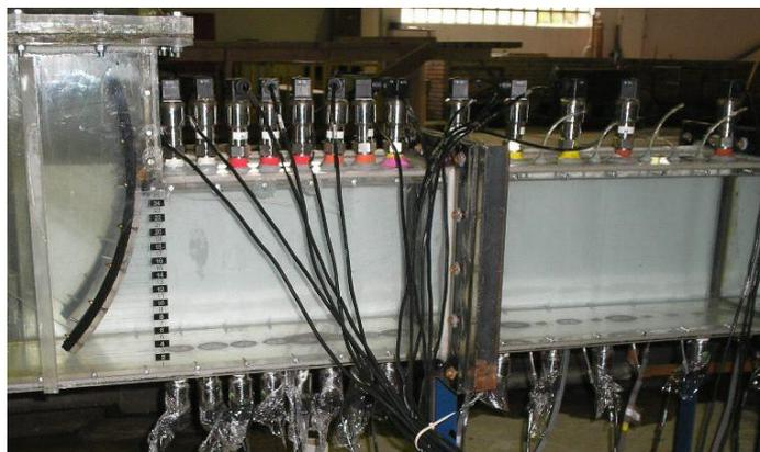
Figura 4 - Transmissores de pressão na base e no teto do conduto (Fonte: Kempka, 2011)
