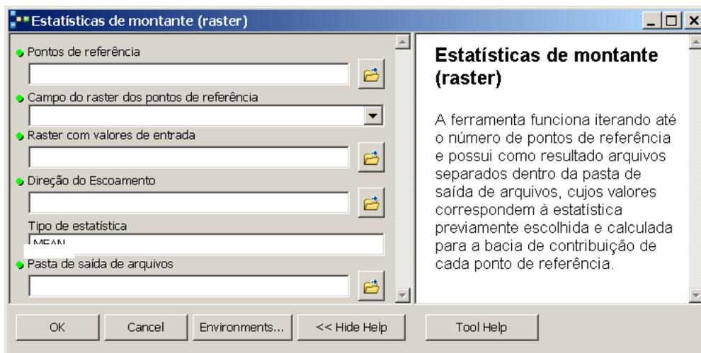
Figura 5 – Interface da ferramenta “Estatísticas de Montante (*raster*)”, que permite o cálculo de estatísticas de dados a montante de pontos de referência, com base em um arquivo *raster* com dados em estudo.
