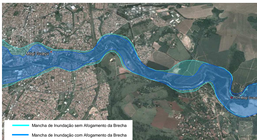
Figura 8. Comparação das manchas de inundação com e sem afogamento geradas a partir dos resultados do CLiv+ (adaptado do Google Earth)
