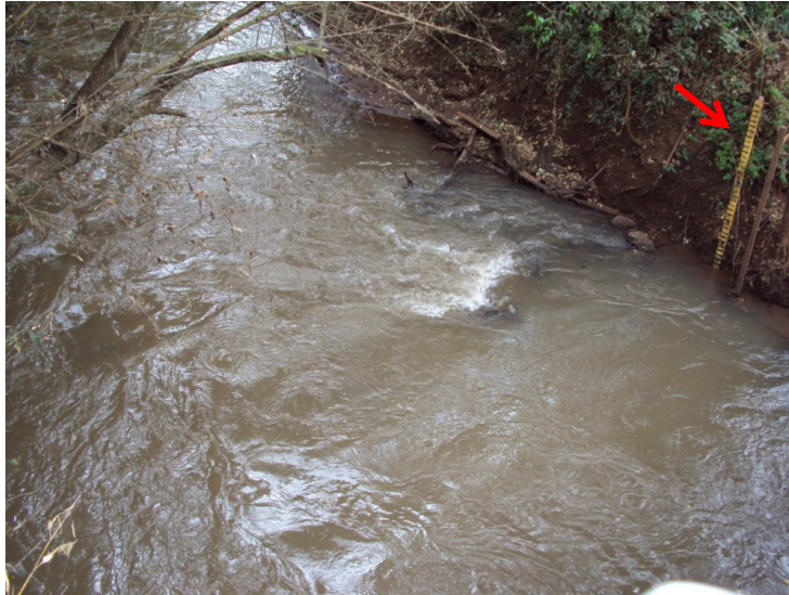
Figura 4 – Seção de estudo e régua para medição de nível do corpo d'água.
