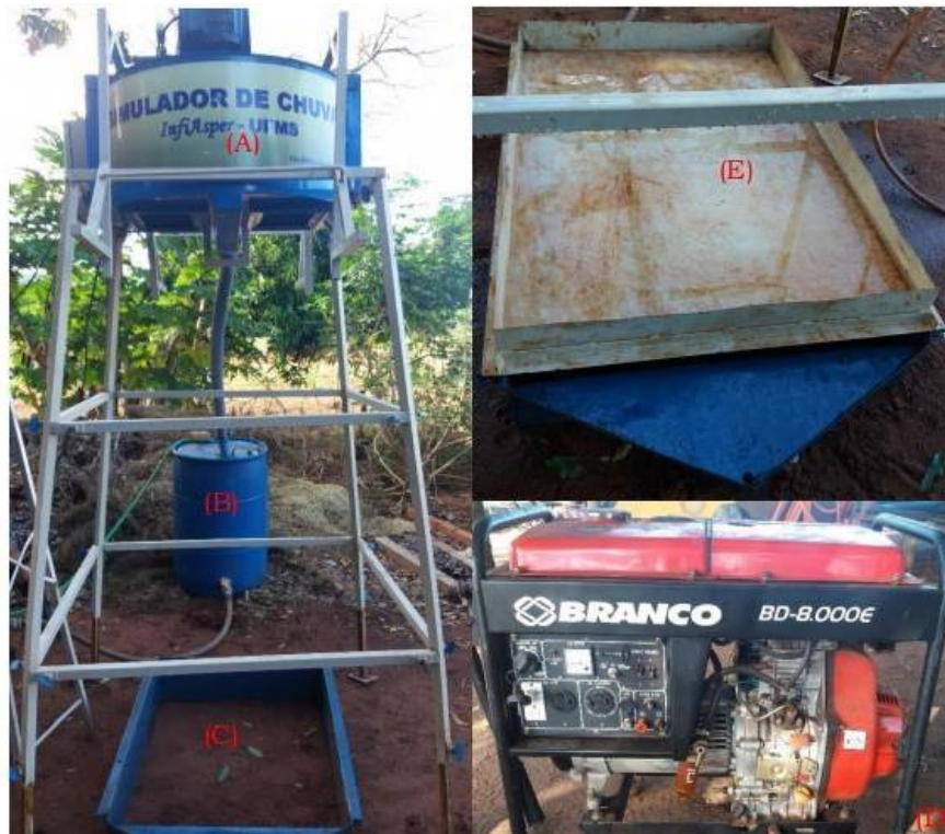
Figura 2: Simulador de Chuva – InfiAsper. A – Caixa reguladora da projeção de chuva, B – Reservatório de água, C – Parcela experimental, D – Gerador de energia, E – Bandeja utilizada para calibração do equipamento.
