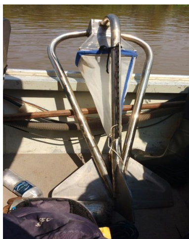
Figura 3 - Amostrador do tipo Helley Smith (fonte: autoria própria).
