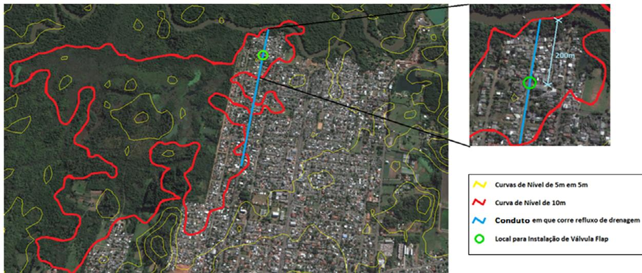
Figura 7 – Local de instalação da válvula *flap* no conduto em que ocorre refluxo de drenagem pluvial, conforme a altimetria do terreno. Fonte: Silveira (2015).
