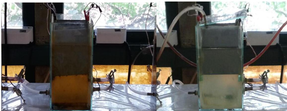
Figura 2 - Reator eletrolítico com eletrodos de aço inox (à esquerda) na primeira fase de operação e reator eletrolítico com eletrodos grafite na segunda fase de operação (à direita).
