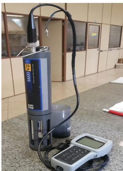
Figura 2 - Sonda Multiparâmetros YSI 6600-V2-2
