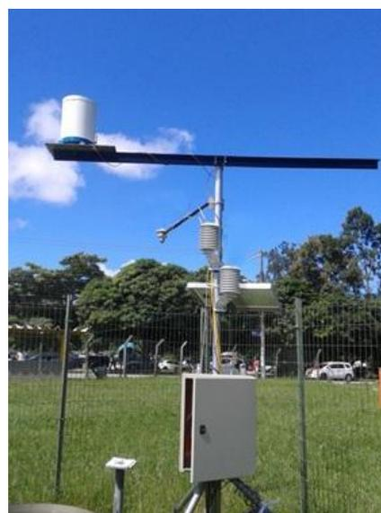
Figura 4 - Estação meteorológica UFSC.
