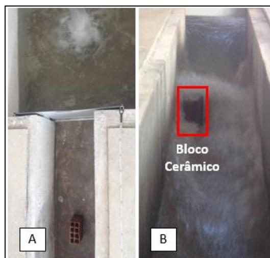
Figura 3. Etapas realizadas: A – posicionamento do corpo de prova e do nível do reservatório; B – retirada da placa liberando o escoamento.
