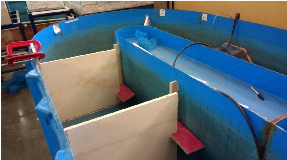
**Figura 3:** Tanque de MTP experimental em construção (foto do autor)
