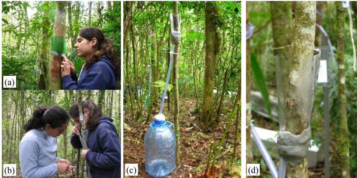
Figura 5 – Instalação dos coletores do tipo colar. (a) Aplicação da massa adesiva epóxi; (b) moldando a massa epóxi; (c) coletor instalado; (d) detalhe do coletor.
