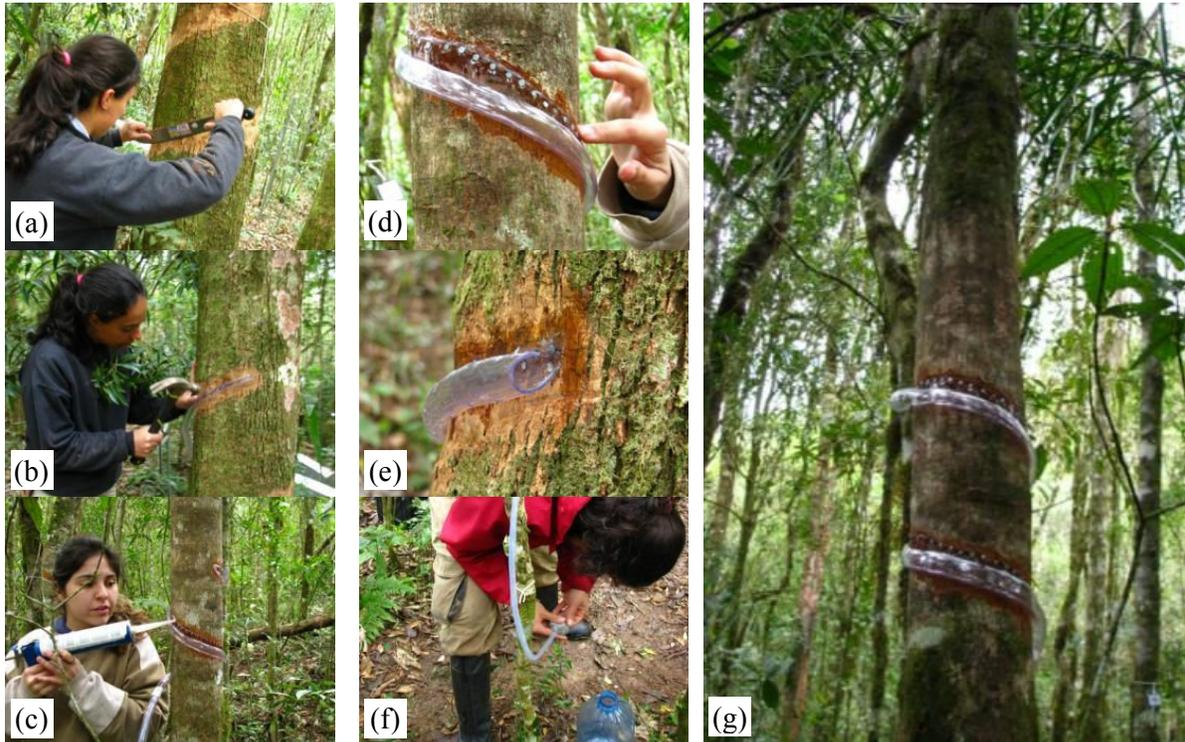
Figura 4 – Instalação dos coletores do tipo espiral. (a) Preparação do tronco; (b) fixação da mangueira; (c) e (d) aplicação de silicone; (e) e (f) coletor instalado; (g) confecção da tampa com massa adesiva epóxi.
