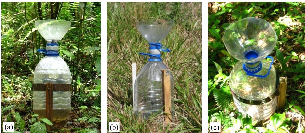
Figura 1 – Pluviômetro construído de garrafas PET: (a) suporte com uma estaca e aro de alumínio; (b) suporte de três estacas; (c) visto de cima, com orifício a mostra.
