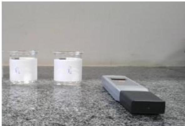
**Figura 2** – Medição da condutividade elétrica.
