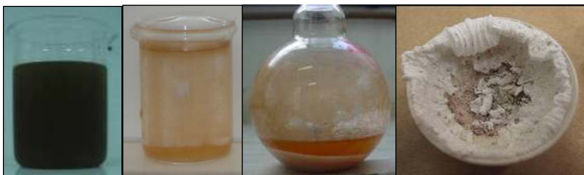
Figura 1. Amostras de AP bruta, após evaporação, e seca em estufa a 100 °C.
