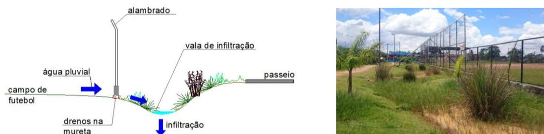
Figura 4. Corte esquemático do funcionamento da vala de infiltração e foto de bacia com acúmulo indevido de água por mais de 24h. Fonte: Autora, 2017.
