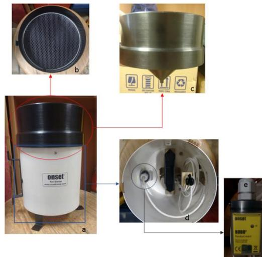
Figura 1 – (a) Pluviógrafo Padrão; (b) Vista aérea do pluviógrafo; (c) Parte superior do pluviógrafo (funil); (d) Parte interna do pluviógrafo; e (e) *Data logger*.
