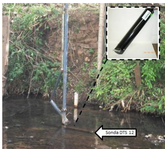
Figura 5 - Localização da sonda do turbidímetro na estação MD IV.
