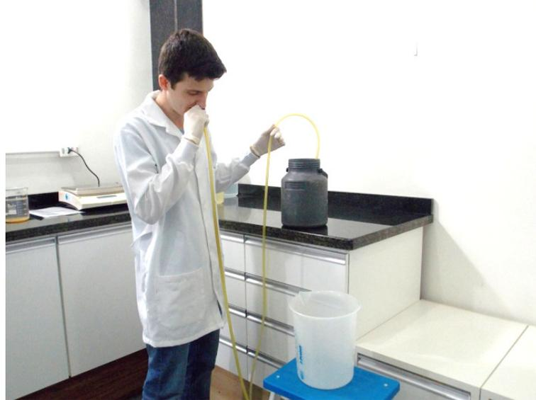
Figura 4 – Demonstração da retirada da água sobrenadante após 96 horas de repouso.
