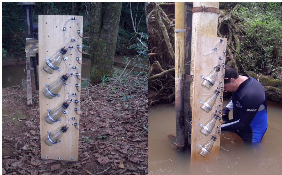
Figuras 6a e 6b – Instalação do coletor de sedimentos
