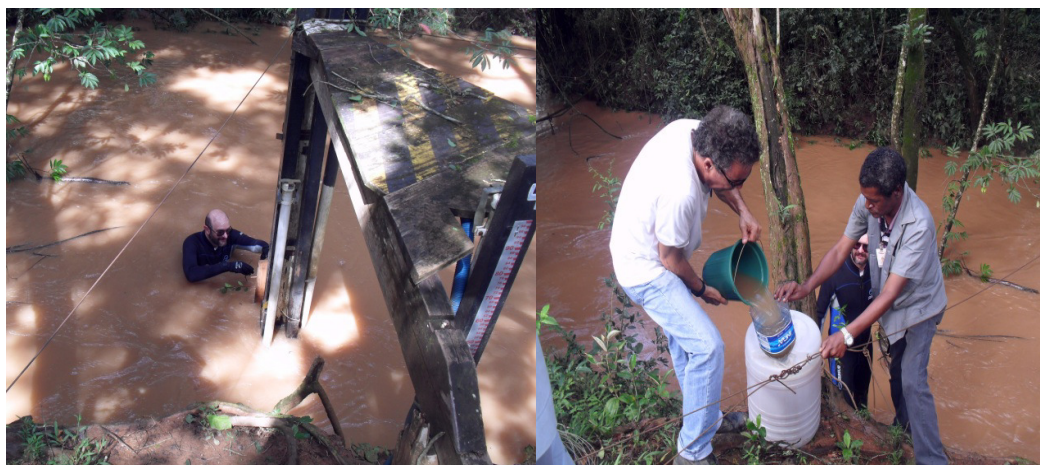
Figuras 7a e 7b – Retirada do coletor de sedimentos e coleta de sedimentos em suspensão
