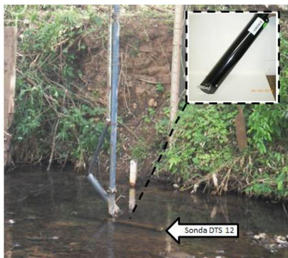
Figura 3 – Suporte da sonda de turbidez.
