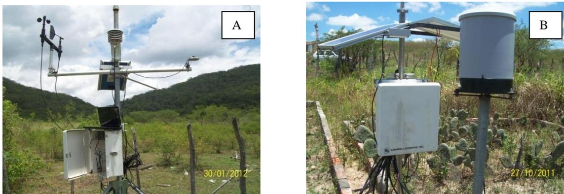
**Figura 2.** Estação climatológica (A) e pluviômetro de báscula (B) instalados na bacia do Alto Ipanema.
