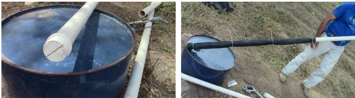
Figura 7 - Piezômetro.
