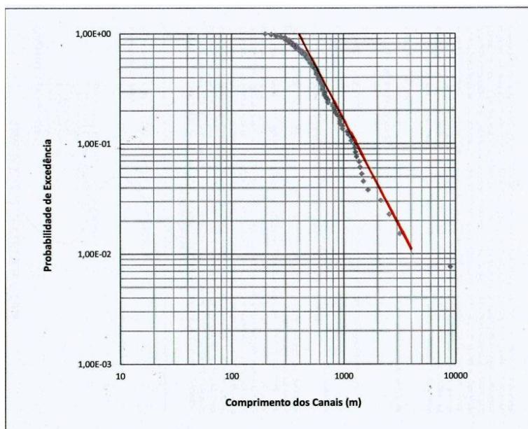
Figura 2 – Dimensão fractal obtida pelo Método da Probabilidade da Excedência do Comprimento de Canais para a Bacia do Ribeirão Marmelo por técnica manual
