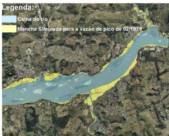
Figura 5 - Simulação da mancha de cheia da vazão de pico de fevereiro de 1979
