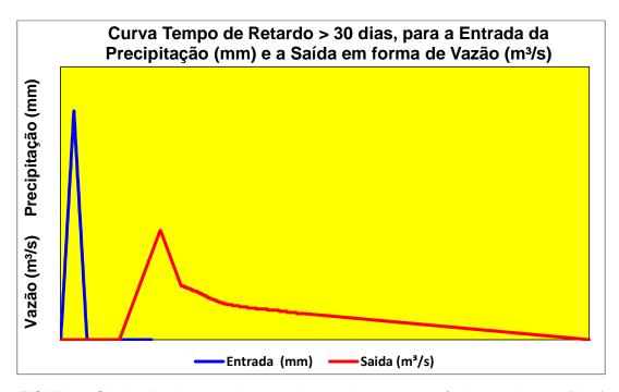
FIGURA 3: Simulação da curva de tempo de retardo para um período superior a 30 (tinta) dias do momento da precipitação até a saída da água numa drenagem efluente. Fonte: Produção própria dos autores.
