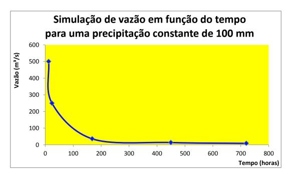
FIGURA 4: Simulação de vazão em diferentes tempos para uma precipitação constante de 100 mm, numa superfície de drenagem de 14.110 km² na bacia hidrográfica do rio Verde. Fonte: Produção própria dos autores.
