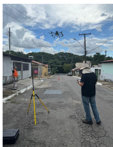
a) Receptor GNSS utilizado em conjunto com o RPA.
