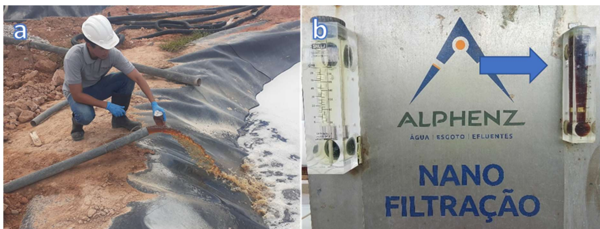
Figura 3: a) coleta da amostra de concentrado do sistema de nanofiltração na ETE do Ecoparque Maceió; b) imagem do painel do sistema de nanofiltração com as correntes de permeado e concentrado.
