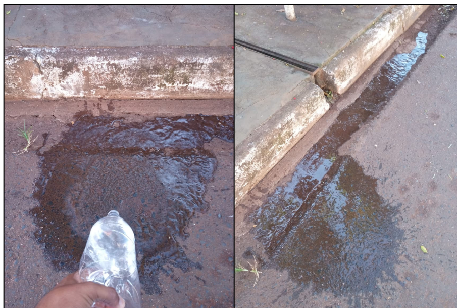
Figura 5 – Obtenção o sentido de escoamento da sarjeta
