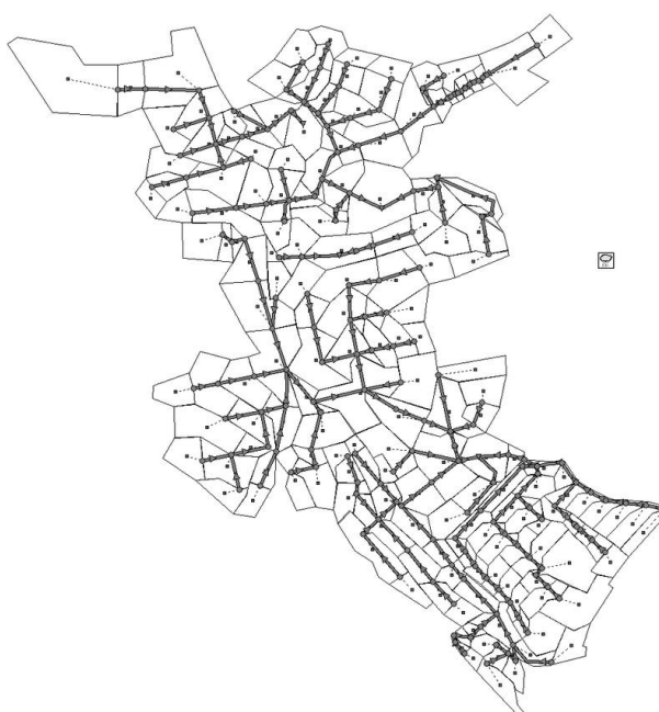
Figura 4 – Rede de drenagem traçada no SWMM
