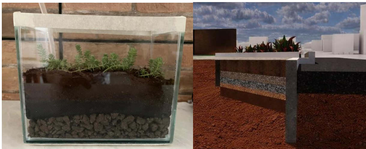
Figuras 4 e 5 - Maquete física das camadas do Telhado Verde e Representação em corte 3D do Jardim de Chuva - Fonte: Autores (2026)
