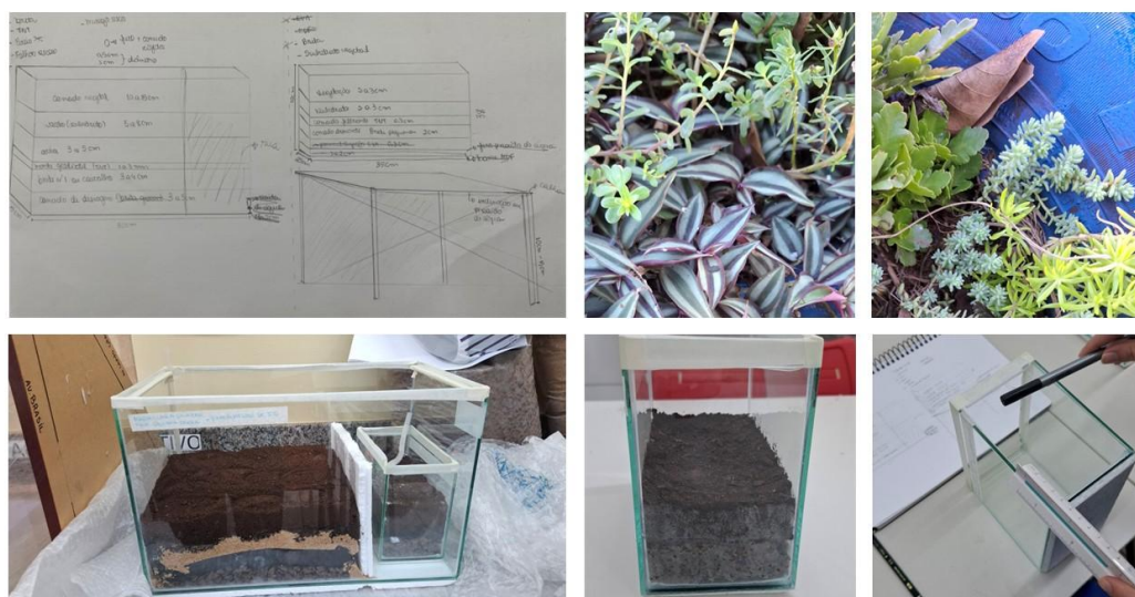
Figura 1: Processo de construção das maquetes de telhado verde e jardim de chuva. Fonte: Autores (2026).
