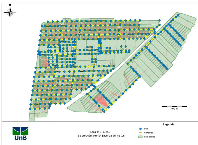
Figura 3 – Rede de drenagem convencional (Elaborado pelo autor)
