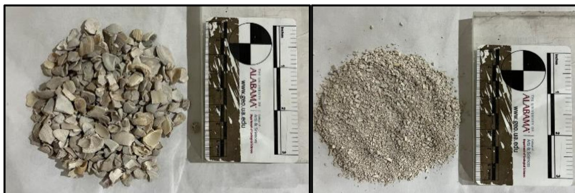
Figura 1 – Variação textural do material bioclástico: areia (0,5-2 mm) e grânulos/seixos (3-8 mm) (Foto do autor).
