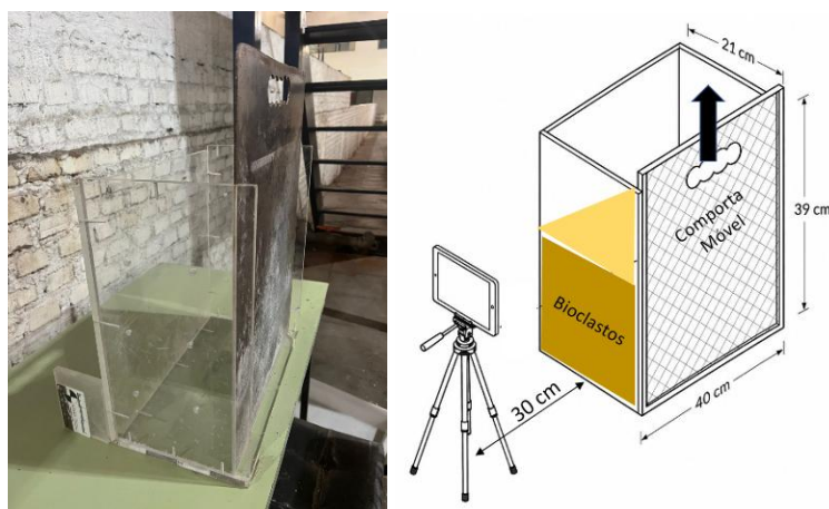
Figura 2 – Foto da caixa com parede móvel (foto do autor) e desenho esquemático (elaborado pelo autor) com as dimensões do aparato e localização da câmera.
