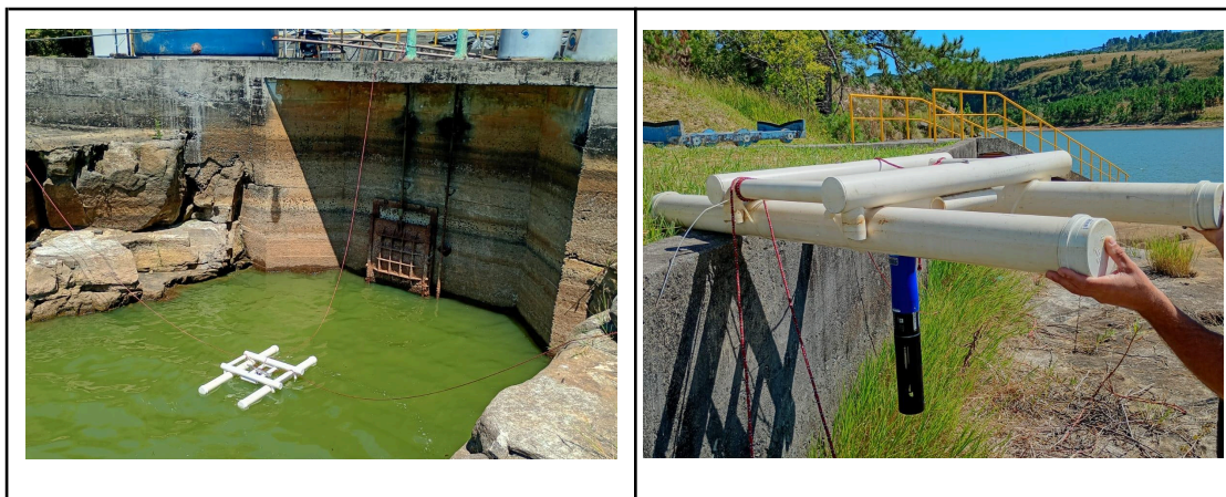
Figura 8. Estação de monitoramento da qualidade da água flutuante. Fonte: O autor 2026.
