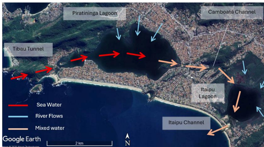
Figura 9 - Quando o Canal de Camboatá é dragado, estabelece-se um fluxo residual, formando uma célula de circulação. A água marinha (setas vermelhas) deriva do Túnel do Tibau em direção ao leste e se mistura com a água proveniente dos rios (setas em azul claro). Essa água misturada (setas em rosa) escoar através do Túnel do Tibau, atravessa a Laguna de Itaipu e deixa o sistema lagunar pelo Canal de Itaipu.
