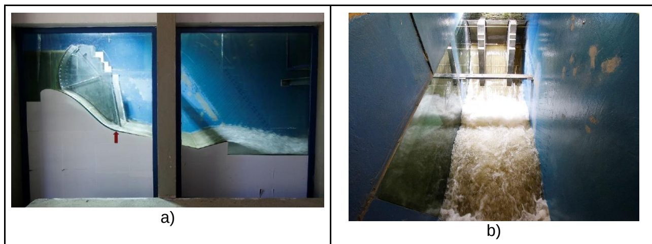
Figura 1. Modelo físico parcial reduzido do sistema extravasor da UHE Foz do Chapecó em vista de perfil (a) e de jusante para montante (b).
