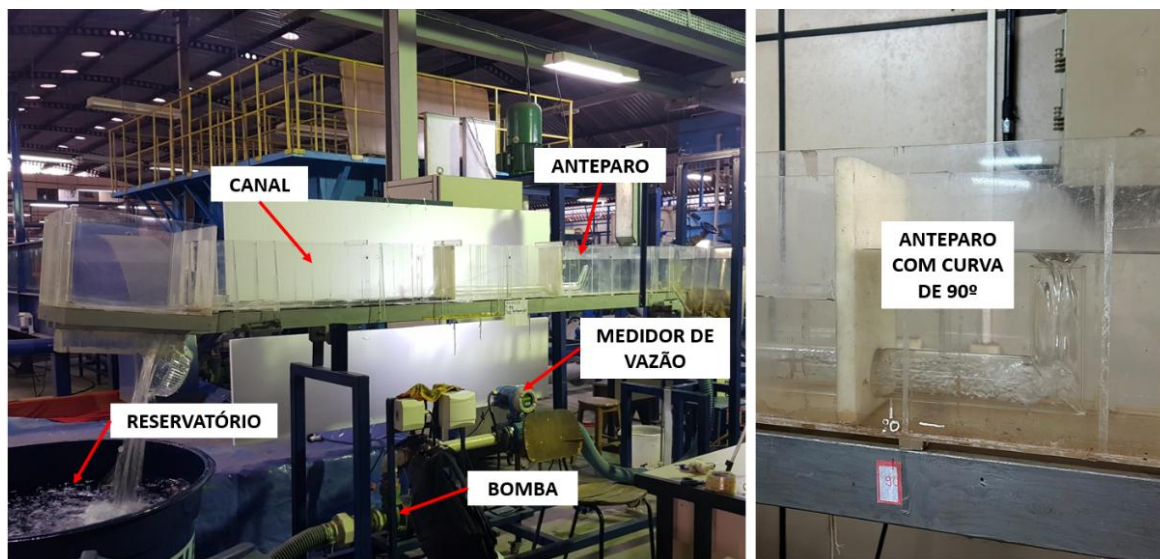
Figura 2 – Canal didático utilizado no estudo (à esquerda) e detalhe do anteparo com curva de 90° adotado (à direita).
