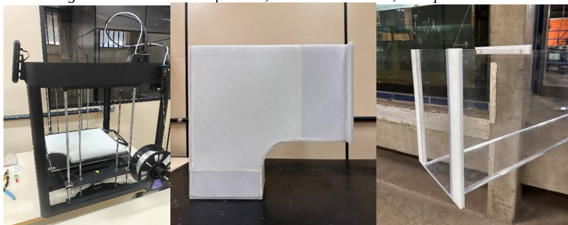
Figura 3: Processo de impressão, detalhe da entrada, e acoplamento da calha
