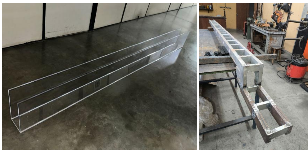
Figura 5: Calha do canal em acrílico e detalhe do suporte metálico
