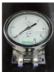
Figura 1 – A) Medidor de vazão eletromagnético; B) Manômetro diferencial tipo Bourdon.
