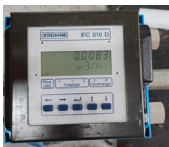
Figura 1 – A) Medidor de vazão eletromagnético; B) Manômetro diferencial tipo Bourdon.
