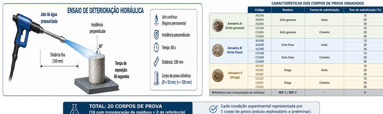
Figura 2 – Esquema de ensaio de deterioração hidráulica (Baseado na ABNT NBR 13276 e 13279).
