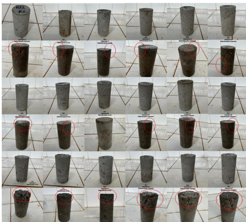
Figura 3 – Registros fotogramétricos dos corpos de prova antes e após ensaio de deterioração hidráulica.
